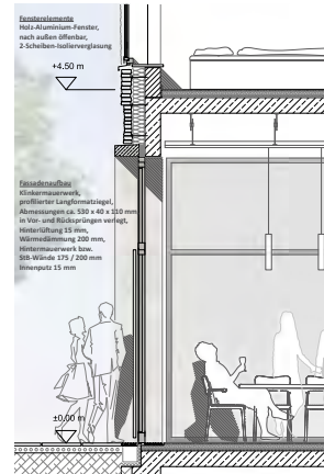
Fassaden-Detaillanschnitt M 1:20
