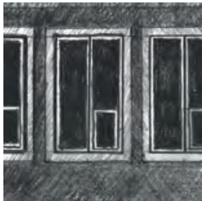
Beispiele von Strukturierungen an Putzoberflächen: Links Rustizierung, rechts Fensterfaschen
