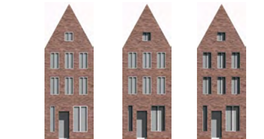
Wirkung einer Fassade mit unterschiedlich tief lie- genden Fenstern: Links sind alle Fenster bündig, in der Mitte nur die in der Mittelzone gelegene, bündig, rechts sind alle Fenster tief eingeschnitten
